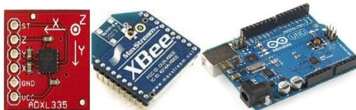
Figura 1. Acelerómetro ADXL3335, Módulos XBee y Tarjeta Arduino UNO.
