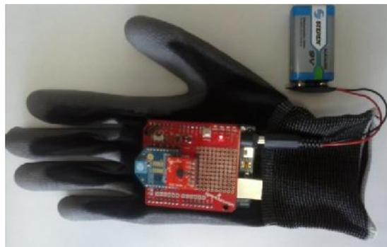
Figura 5. Circuito montado en el guante.
